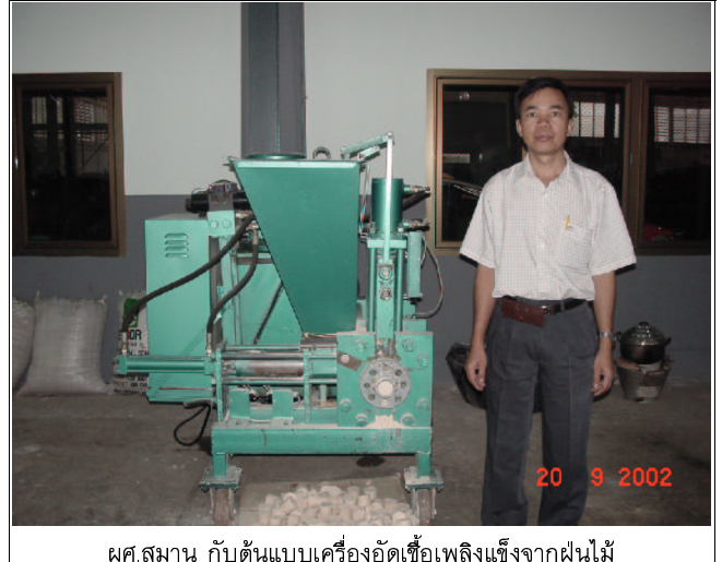
ผศ.สมาน กับต้นแบบเครื่องอัดเชื้อเพลิงแข็งจากฝุ่นไม้
