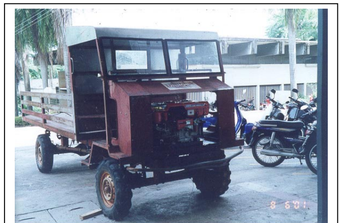
รถอีแต่นติดตั้งเครื่องยนต์เพื่อทดสอบการใช้น้ำมันปาล์ม
