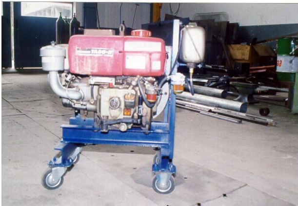
เครื่องยนต์ดีเซลใช้น้ำมันปาล์ม
