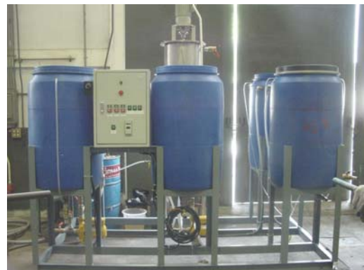
เครื่องผลิตไบโอดีเซล 300 ลิตรต่อวันสำหรับชุมชน
